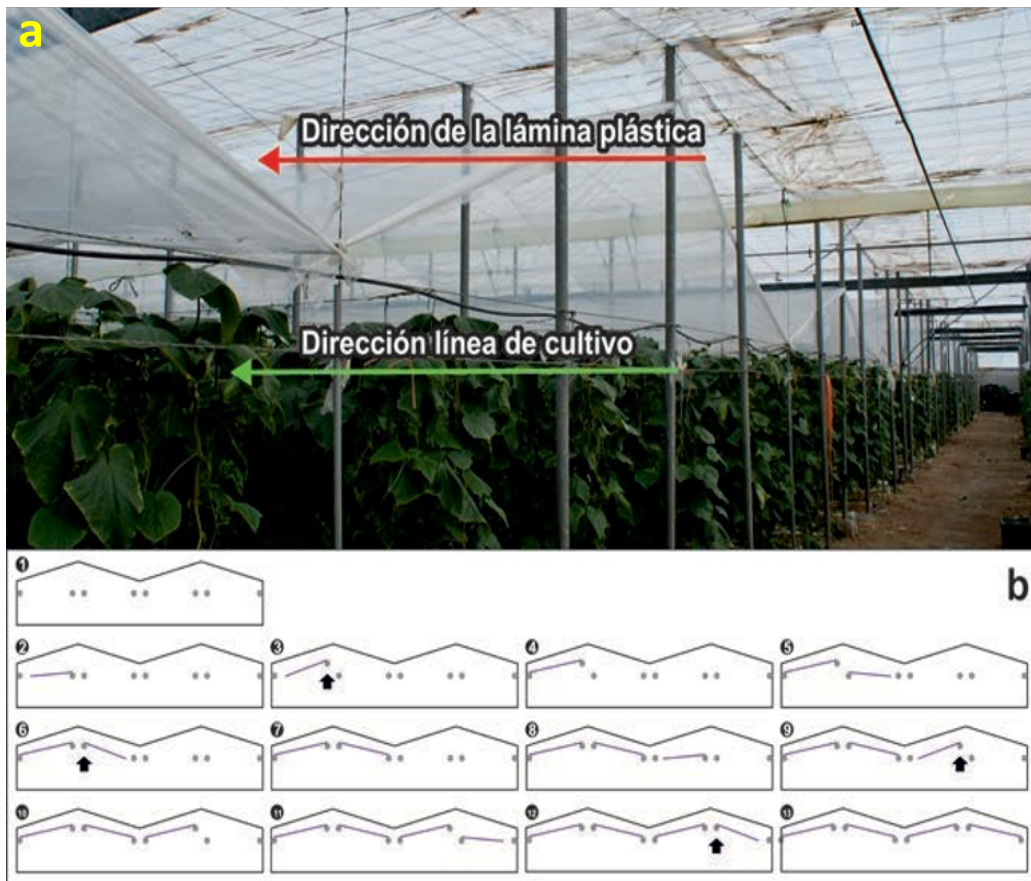
Fotografía 7. a) Doble techo con las láminas de plástico extendidas paralelamente a las líneas de cultivo. b) Esquema de: 1) colocación de los alambres; 2) extensión de las láminas plásticas, fijándolas al alambre libre bajo la raspa; 3) el alambre libre se eleva; 4) el otro extremo de la lámina plástica se fija al alambre fijo bajo el amagado; 5) a 13) se repite quedando el doble techo abierto en las raspas y en los amagados.
