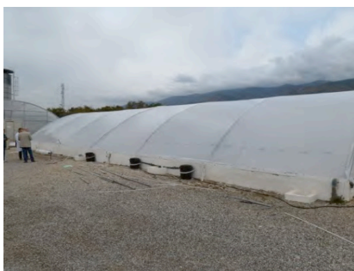
Fotografía 2. Invernadero experimental para medir la condensación de agua bajo dos materiales de cubierta, uno antigoteo y otro estándar.
